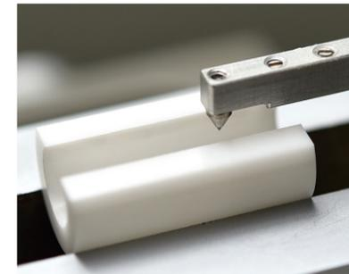
表面粗さ測定器による測定
