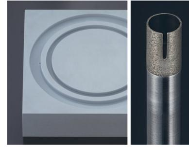
幅10mm深さ4mmの円弧溝加工
