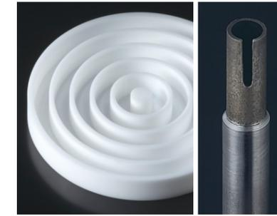
幅5mm深さ8mmの円弧溝加工
