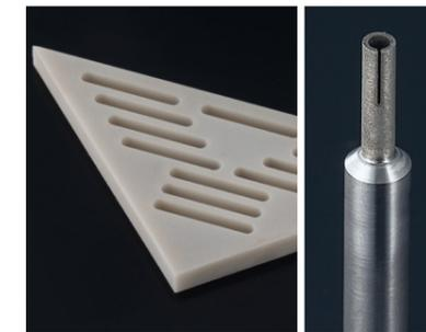
幅3mm深さ5mmの止まり溝加工
